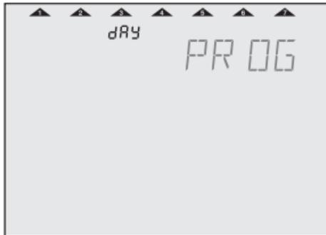
Wählen Sie mit den unteren +/- Tasten Tage oder Tagesblöcke zur Programmierung aus und bestätigen Sie mit OK.
