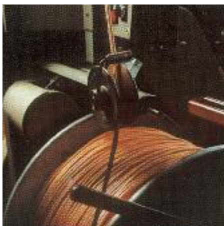
Raccolta cavo schermato.
