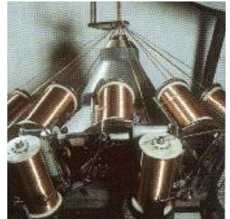
Spiralatura per dielettrico a tubetto.
