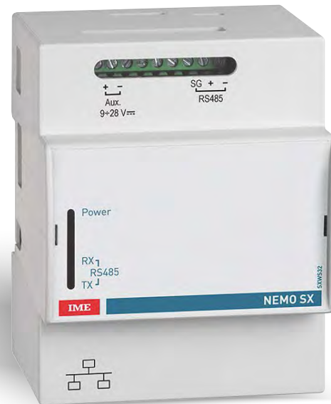
Web server (DIN version) für 10 (item code SXWS10) oder 32 Modbus Adressen oder Impulsmodule (Bestellcode SXWS32).
