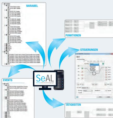
**SEAL (Seneca Advanced Language)** ist eine Seneca Software mit der durch die objektorientierte Programmierung das Management der Steuerungen, Automatisierungen, Alarmer, Grenzwerte und Berichte möglich ist, mit der Möglichkeit der Fernkonfiguration und Fernupdate über SIM oder statischem IP.
